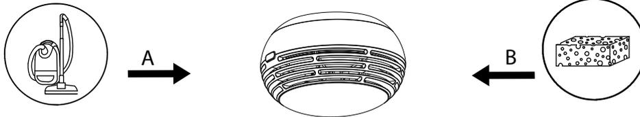
A : Retirez la poussière dans les ailettes à l'aide d'un aspirateur ou un chiffon antistatique.
